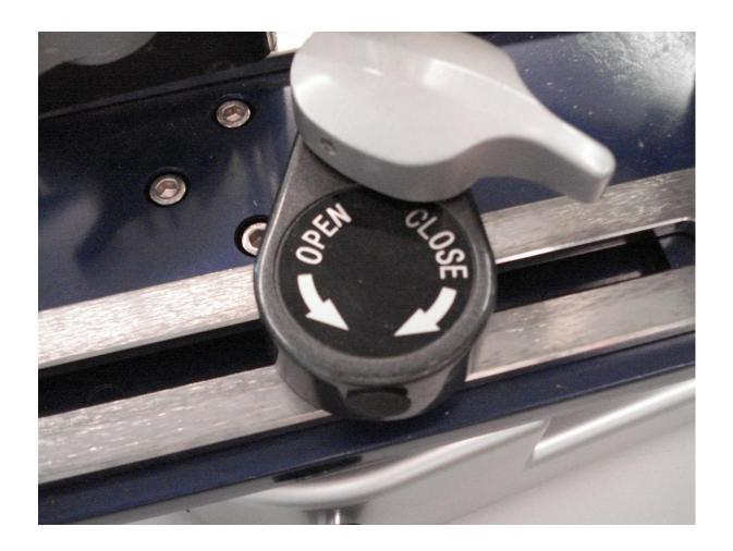
Zum Feinjustieren, die schwarze Gummiabdeckung entfernen und mit einem Inbuss den kleinen Schrauben, der ca 4 cm innerhalb ist, ganz leicht nachjustieren. Die Schraube unten muss nicht nachjustiert werden. Die 2 Schrauben am Schnapper haben nichts mit der Feinjustierung zu tun.
